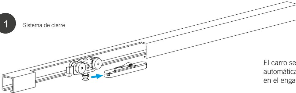
El carro se puede acoplar automáticamente. Posicionar el carro en el enganche y presionar.
