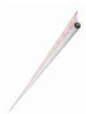
Es el sistema antiplastamiento de los dedos para puertas de hoja batiente más ligero y sencillo posible. Se instala rápidamente con cinta adhesiva de doble cara y protege el punto de cizallamiento entre la puerta y el marco por el lado exterior de la bisagra de las puerta de madera. Asociado a los modelos FINGERPRO DESLIZANTE o FINGERPRO
