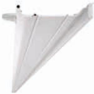
Sistema de protección antiplastamiento de dedos para puertas de hoja batiente que protege el punto de cizallamiento entre la puerta y el marco en el lado externo de la bisagra. Consta de varios perfiles de aluminio abisagrados entre sí que permiten abrir la puerta hasta 120° y proteger totalmente el punto interno de cizallamiento entre la puerta y el marco.
